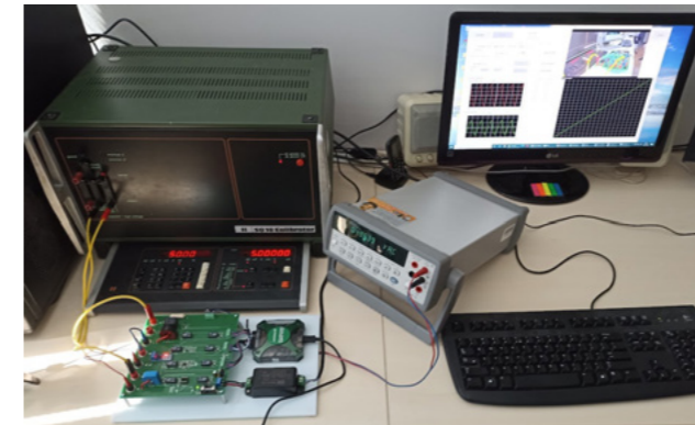
Stanowisko laboratoryjne do badania czujników prądu
