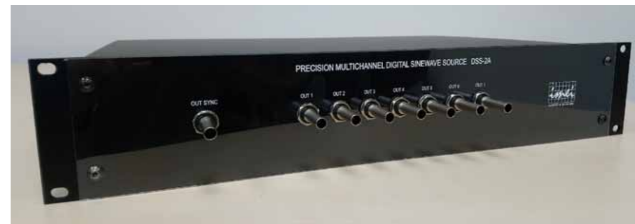
Fot. 2. Cyfrowy generator napięć sinusoidalnych opracowany przez zespół z Instytutu Metrologii, Elektroniki i Informatyki (IMEI), pod przewodnictwem dr. hab. inż. Ryszarda Rybskiego, prof. UZ
